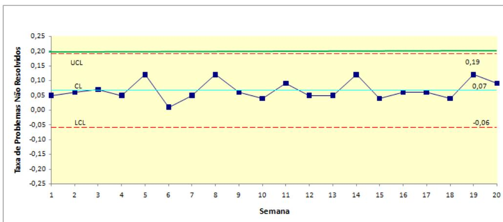
Figura 9 – Processo de manutenção após melhoria contínua: estável, capaz e com melhor desempenho (limites mais estreitos).
