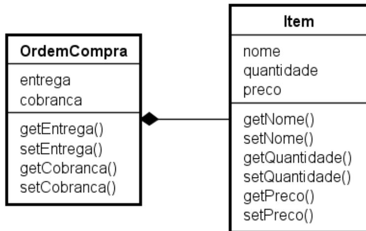
Figura 1 – Classes do diagrama do exemplo em UML.
