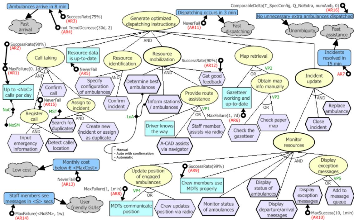
Figura 10 – Exemplo de modelos de objetivos de um sistema de despacho de ambulâncias (SOUZA, 2012).
